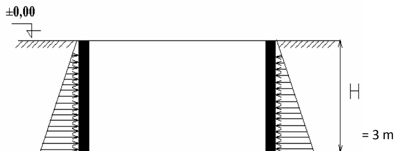
Figure VI.16 : Poussées des terres.
