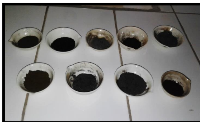
Figure 5 : Creusets après la carbonisation
