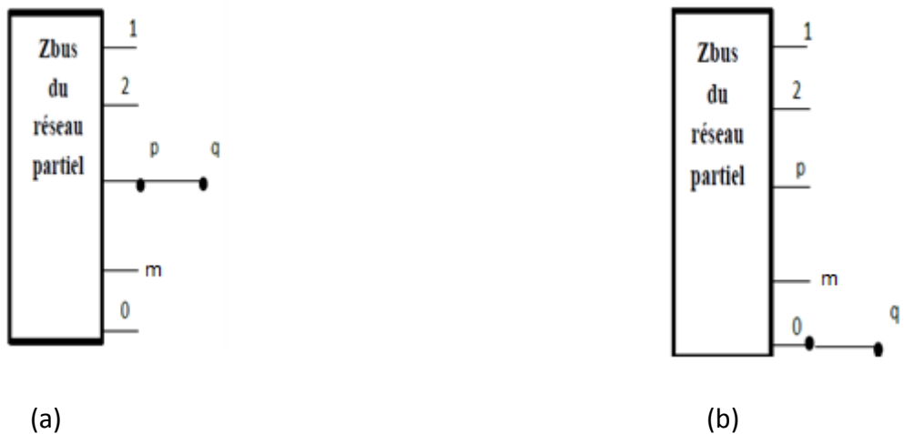
Figure (III.4) Addition d'une branche à un nœud quelconque (a) et au nœud de référence (b).
