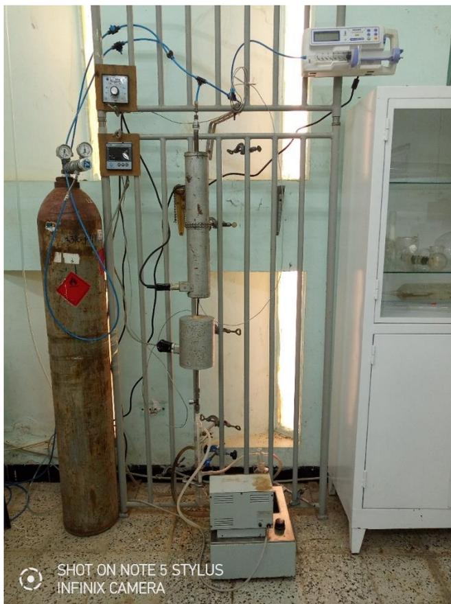
Figure III.5 : dispositif expérimental de reformage catalytique du glycérol
