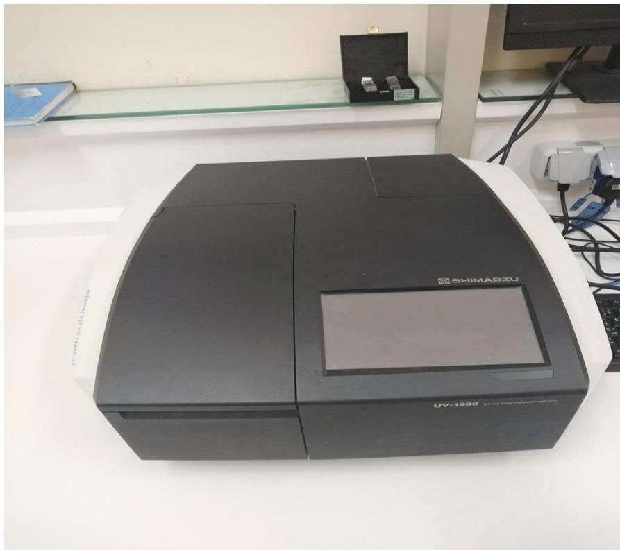
Spectrophotomètre UV visible (UV-1900)
