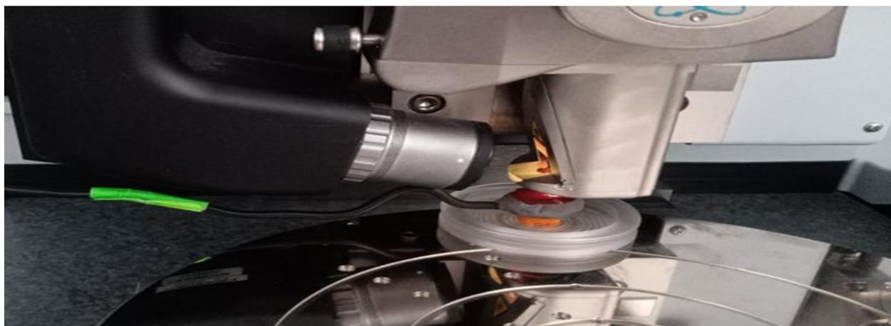
**Figure 2.06** : Caractérisation AFM des échantillons.
