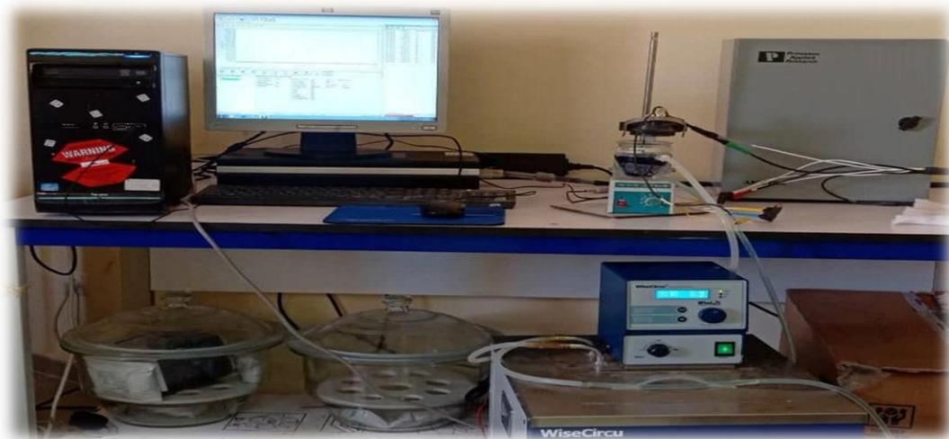
**Figure 2.05:** Représentation schématique du dispositif expérimental utilisé pour l'élaboration des nanostructures de  $\text{Cu}_2\text{O}$ .
