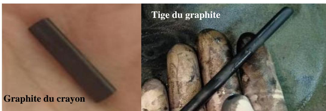
**Figure 2.03:** Les deux substrats du graphites utilisées.
