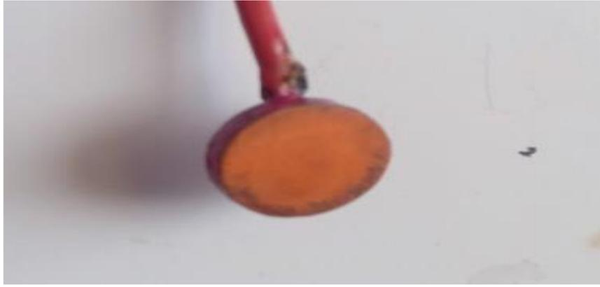
**Figure 3.11 :** Photo de substrat du cuivre après le dépôt de 20 min
