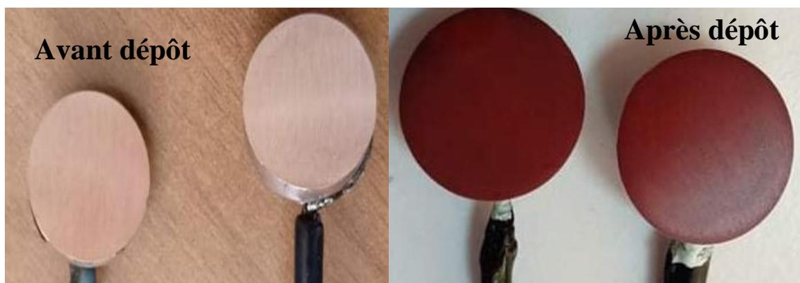
**Figure 3.07 :** Photos de substrat de cuivre avant et après dépôt
