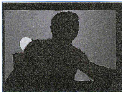
Figure 31 : Image de profondeur fournie par la Kinect [54].
