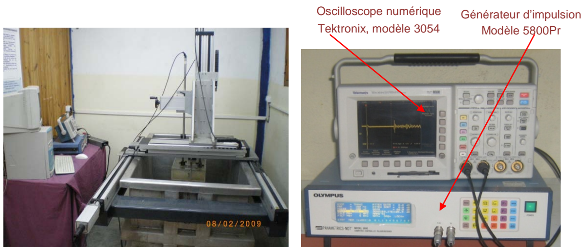
Figure III.3 : Dispositif expérimental (caractérisation ultrasonore)
