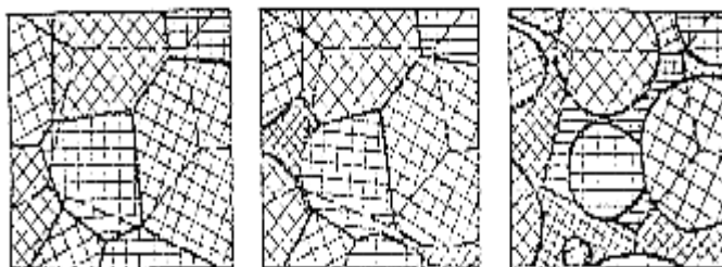
Figure I.11 : Evolution des grains lors de la recristallisation secondaire [15]
