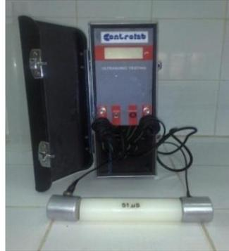
Figure 4.5: Appareil d'ultrason
