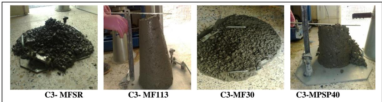
Figure 4.10: Résultats d'essais d'ouvrabilité sur les bétons
