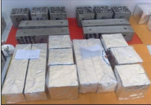
Figure 4.3 : Modes de conservation des éprouvettes de béton.
