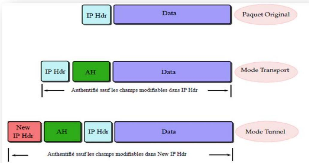
Figure 2-4 : Trame AH en mode tunnel et transport [12]
