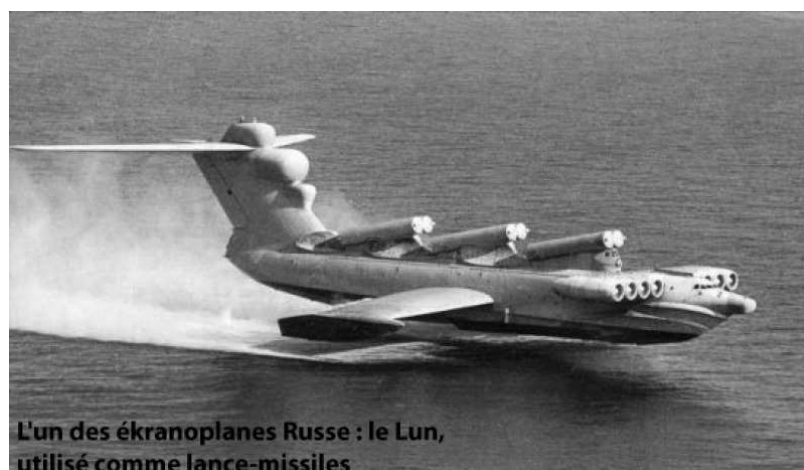
Figure 1.2 L'un des ékranoplanes russes : le LUN, utilisé comme lance-missiles
