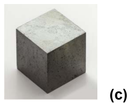
Figure 2-3: Dispositif de boruration des échantillons: (a) Conteneur des échantillons, (b) disposition des échantillons dans le conteneur et (c) Echantillon boruré sur six (06) facettes.
