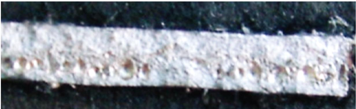
**Figure 4.50 :** Apparition de soufflures après l'essai de traction
