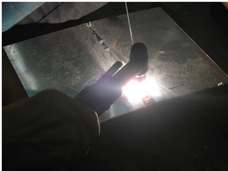
**Figure 4.6 :** Application et influence de la vitesse de soudage sur l'échantillon (épaisseur = 2 mm)
