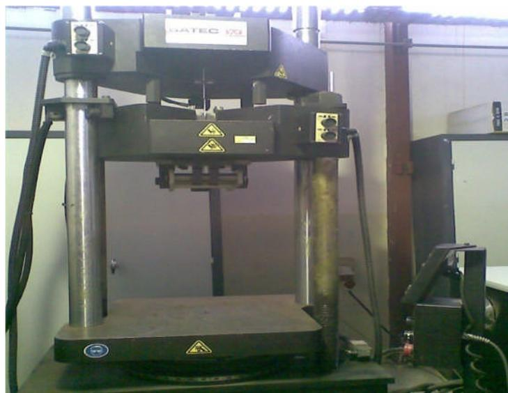
**Figure 3.21** : Machine de traction de marque Instron
