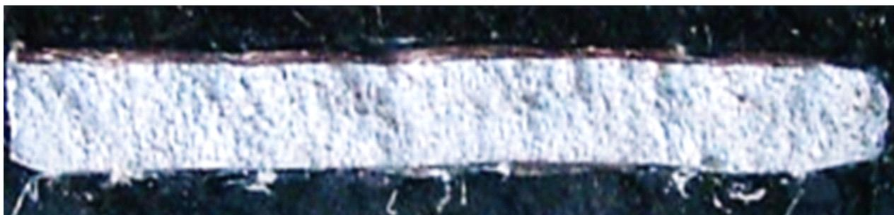
**Figure 4.47:** Vue de profil de la déchirure apparue après l'essai de traction (épaisseur = 2mm)
