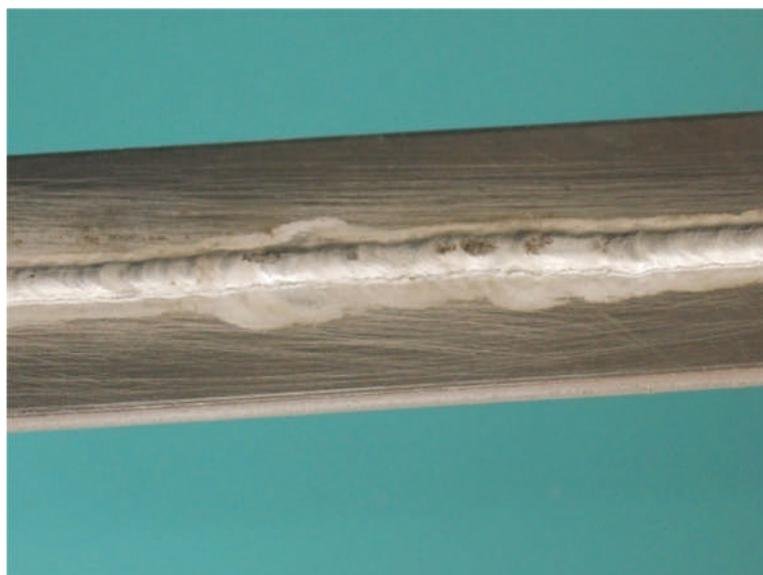
**Figure 2.21 :** Apparition d'une fissure lors du soudage TIG d'un alliage d'aluminium 7075 T6 (épaisseur = 2 mm)
