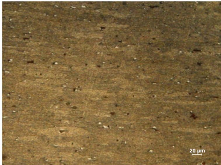
**Figure 4.8 :** Micrographie du métal de base de l'échantillon soudé et non traité sur l'échantillon d'épaisseur = 2 mm
