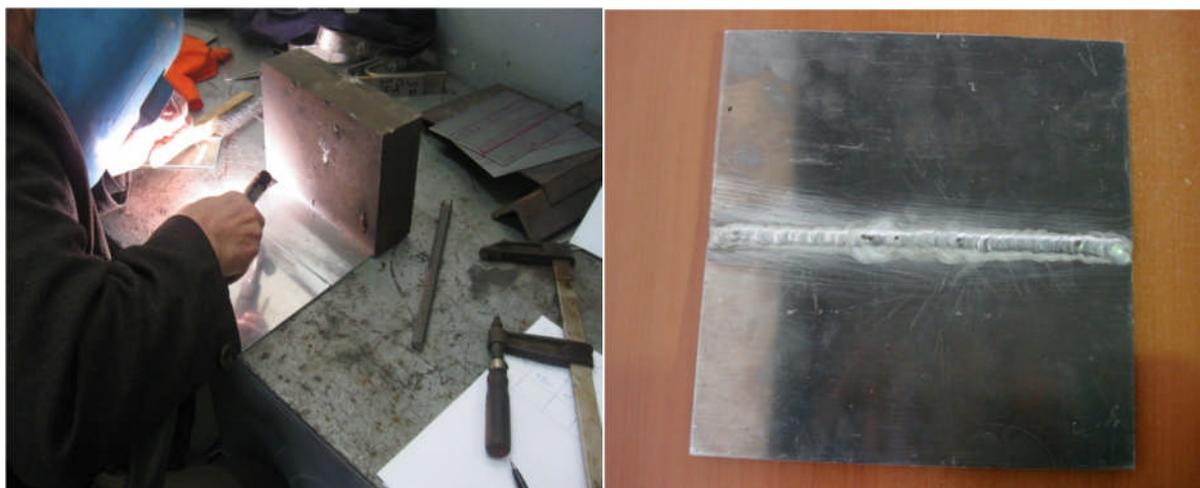
**Figure 3.7 :** Plaques soudées (épaisseur = 2.5 mm)
