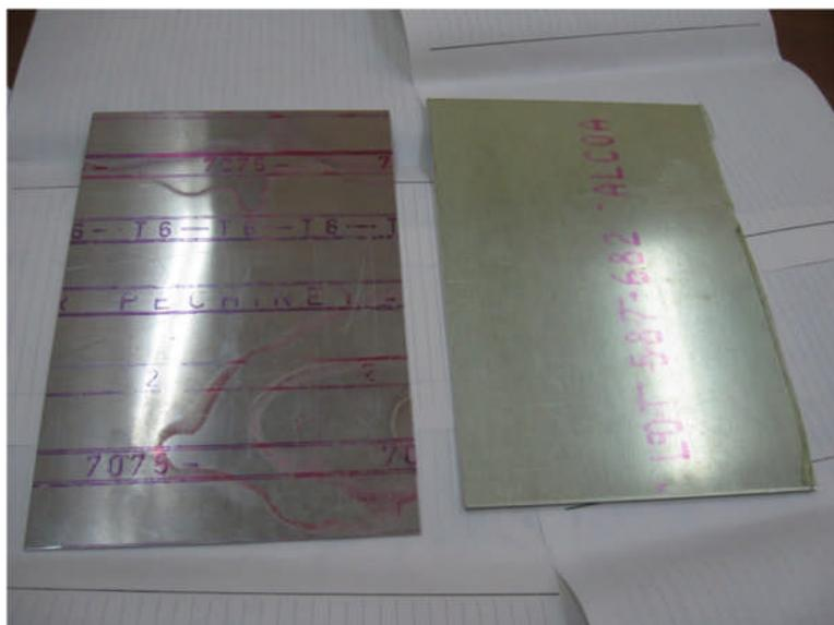
**Figure 3.1 :** Plaque brute d'aluminium 7075 T6 (épaisseur = 2 mm)
