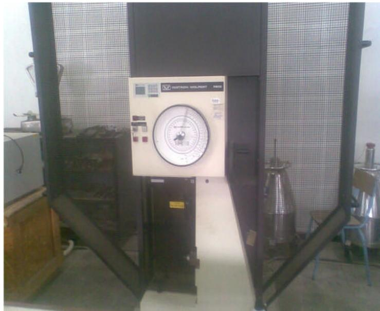
**Figure 3.20** : Machine de résilience de marque Instron
