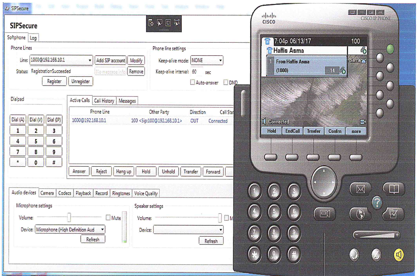
Figure 33 : Etablissement d'un appel avec SIPSecure
