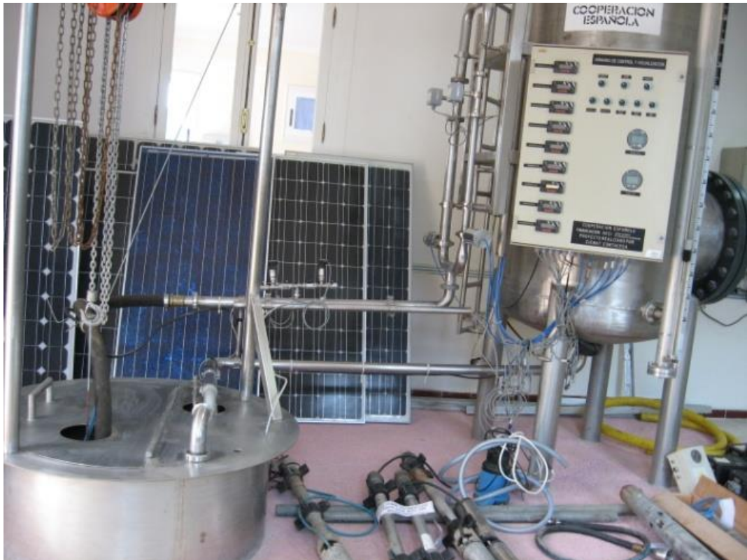
(a) Banc d'essais de pompage du CDER
