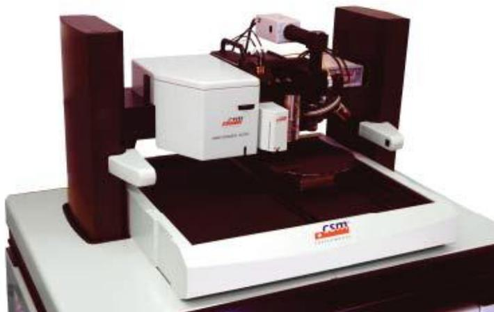
**Figure.3.25** Appareil de nanoindentation utilisée
