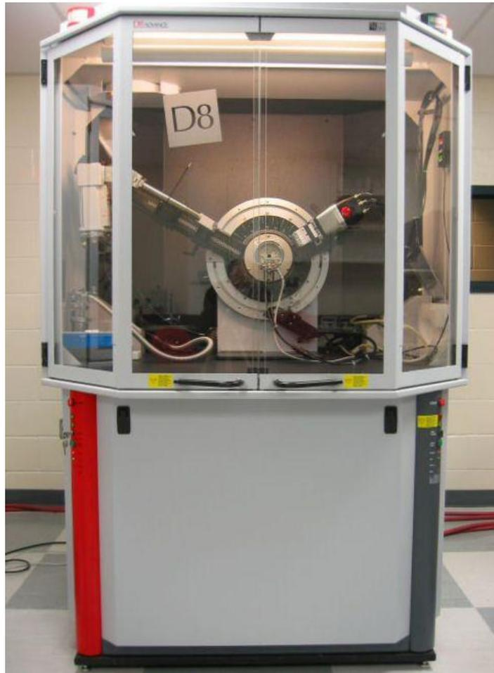
**Fig.3.14** Diffractomètre de type Bruker ADVANCE 8
