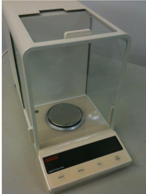
**Figure.3.2.** Balance de précision utilisée pour la pesée des poudres
