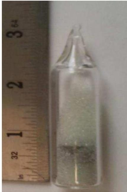
**Figure.3.6** Echantillon après la mise sous vide
