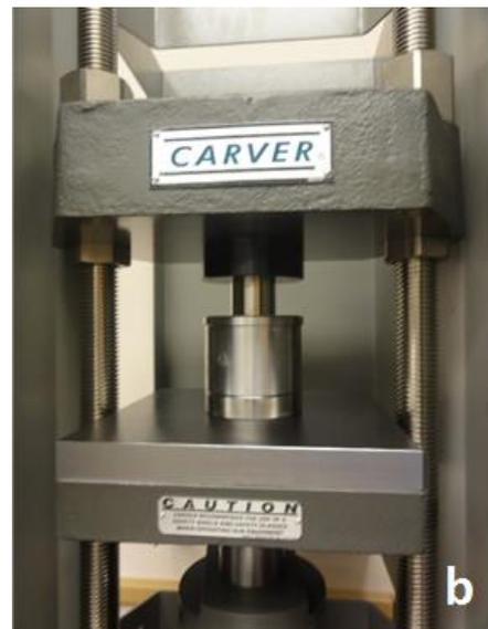
**Figure 3.4 a)** matrice utilisée pour le compactage, **b)** presse hydraulique uniaxiale
