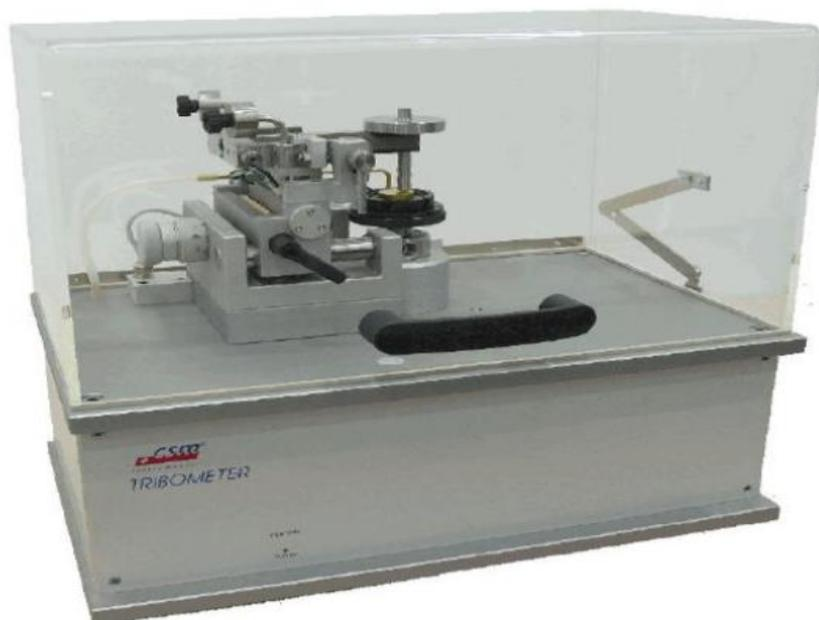
**Figure.3.27** Appareil pion sur disque utilisé
