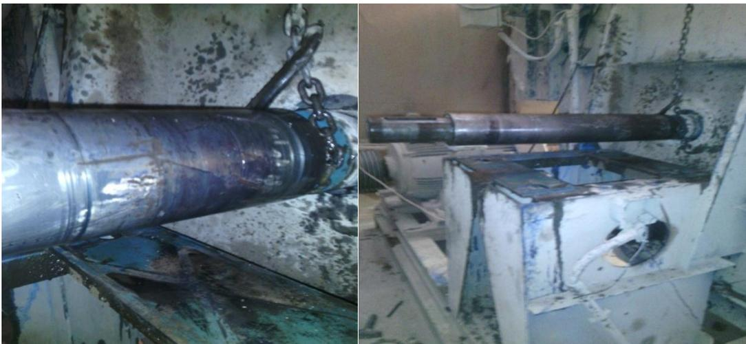
**Figure 2.24 :** Usure d'une portée de roulement sur l'arbre de l'atomiseur
