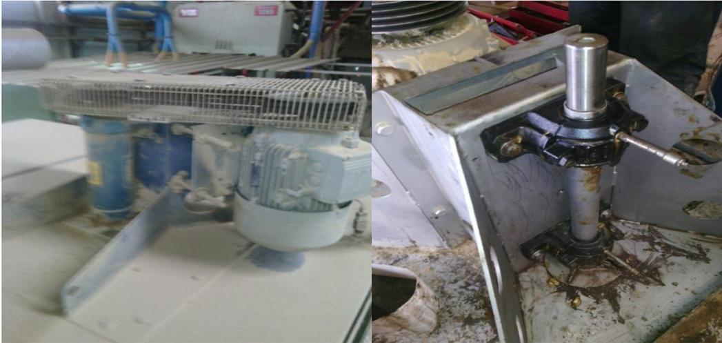
**Figure 1.12 :** Déformation du rotor portant la turbine d'un ventilateur de répartition de chaleur dans un séchoir d'une céramique
