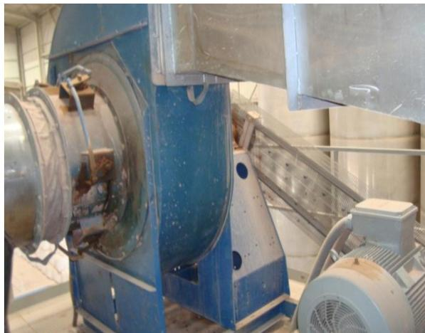
**Figure 2.21** : Photo du ventilateur atomiseur
