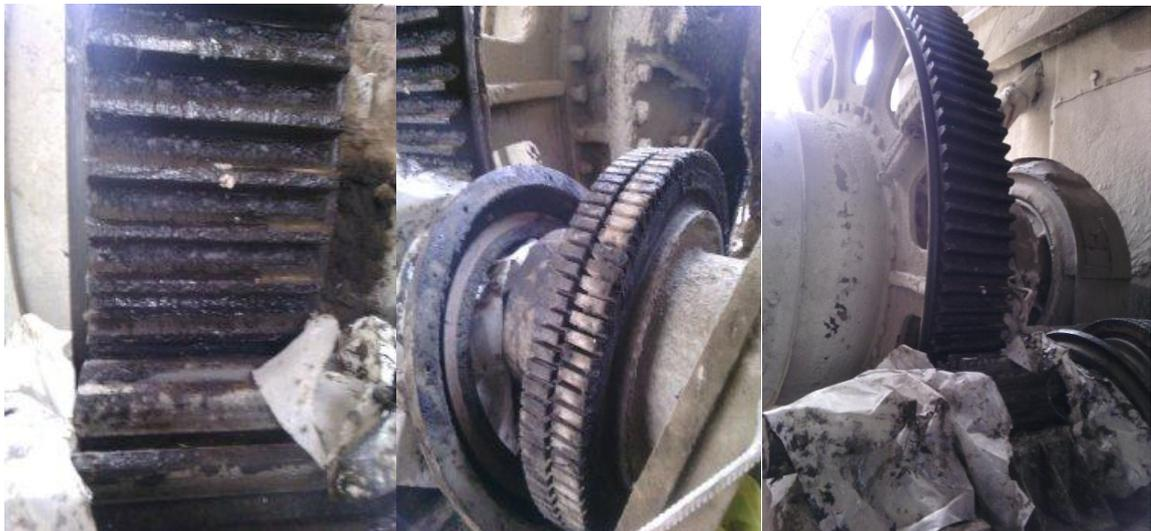
**Figure 2.16 :** Photos indiquant l'engrènement entre le pignon d'attaque et la grande couronne, ainsi que l'accouplement reliant les deux arbres entrainant et entrainé du pignon d'attaque
