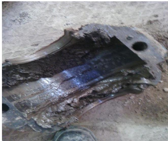
**Figure 2.28:** Palier usé de l'arbre portant la turbine du ventilateur exhaure ciment
