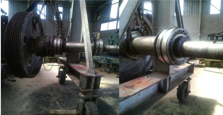
**Figure 1.10 :** Déformation (flexion) après une période d'arrêt d'un rotor d'un concasseur
