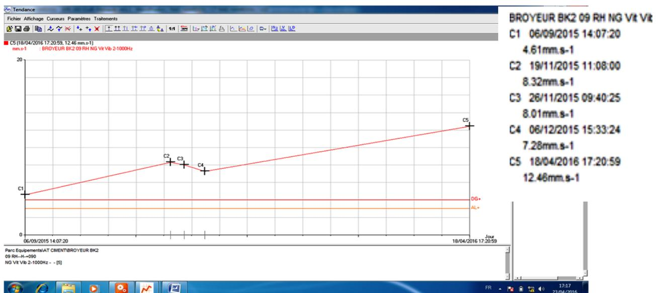
**Figure 3.2 :** Tendence vibratoire du BK 02 sur le palier N°09 dans le sens horizontal
