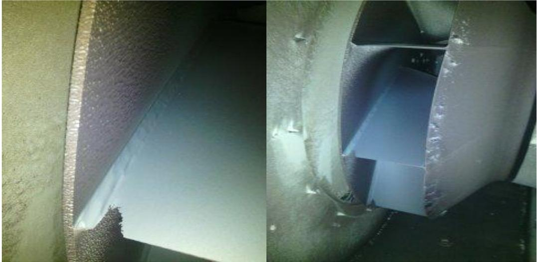
**Figure 2.22 :** Photo de la turbine de l'atomiseur indiquant l'usure flagrant sur ses pales
