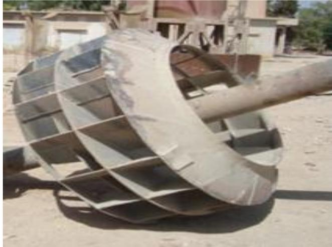
**Figure 2.27:** Turbine du ventilateur exhaure ciment
