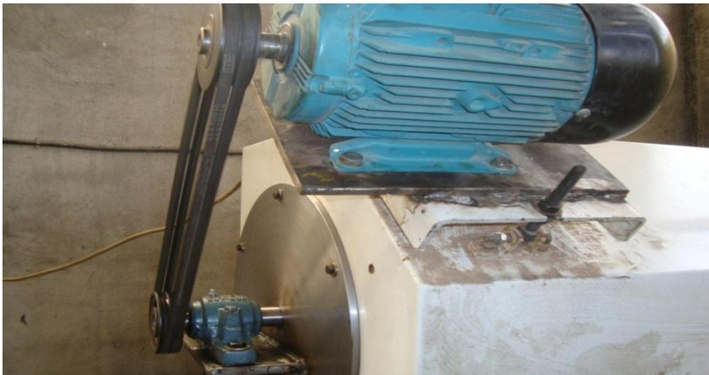
**Figure 4.11 :** Alignement entre le moteur et l'arbre de transmission
