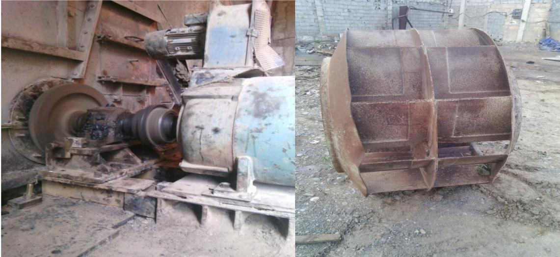
**Figure 2.18 :** Photo du ventilateur aspirateur fumée et photo du rotor portant la turbine du ventilateur aspirateur fumée
