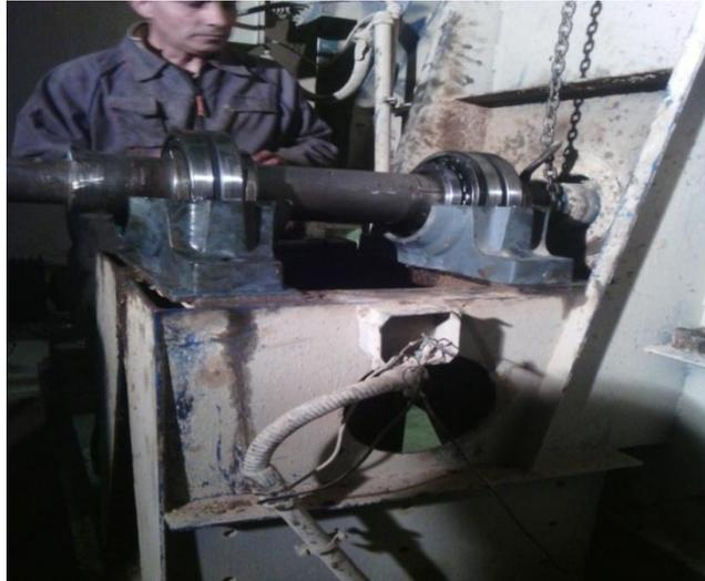
**Figure 2.25 :** Photo de indiquant le montage des paliers et roulement de l'atomiseur
