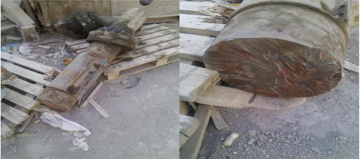
**Figure 2.17 :**Photos indiquant le cisaillement de l'arbre portant le pignon d'attaque réducteur N°2
