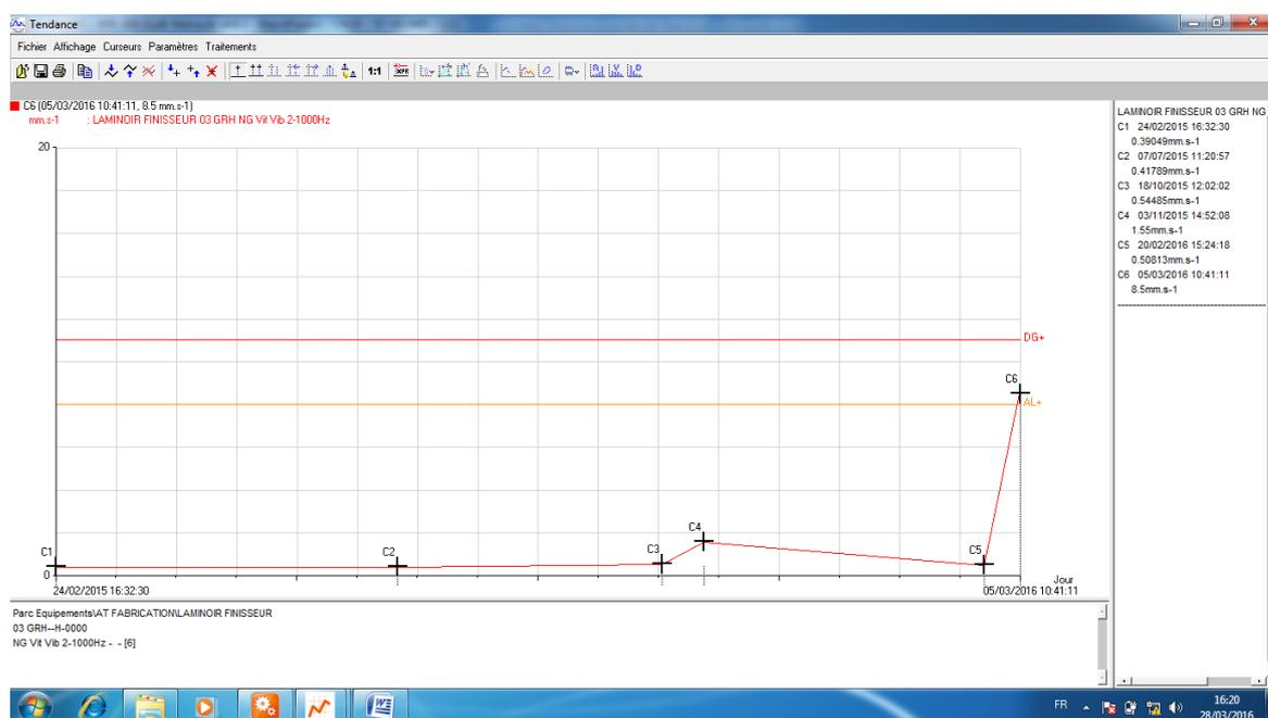
Figure 2-1 : Tendence vibratoire du laminoir finisseur sur le palier N°03 dans le sens radial horizontal du cylindre Grande vitesse (GV).
