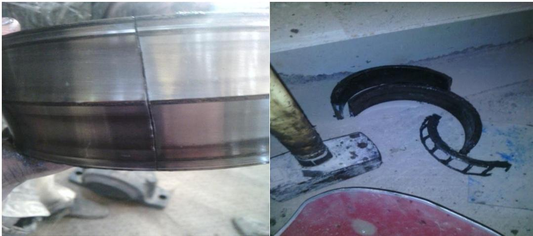
**Figure 2.23 :** Détérioration du roulement et cassure de la bague intérieure
