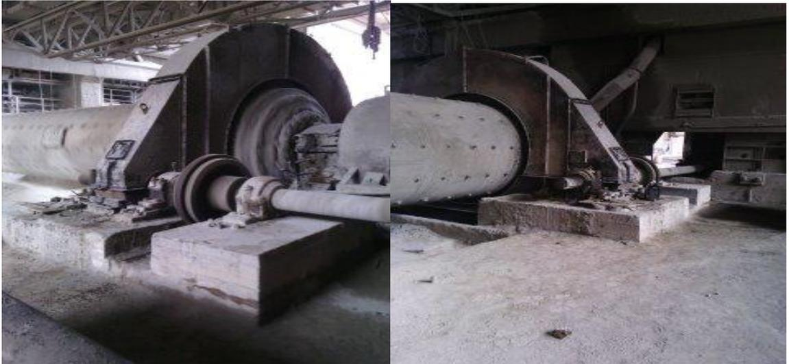
**Figure 2.15 :** Photos du réducteur N°02 de la sortie du broyeur
