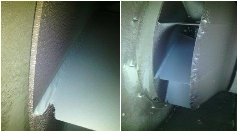
**Figure 1.9 :** Perte de matière sur les pales d'une turbine d'un Atomiseur/Céramique
