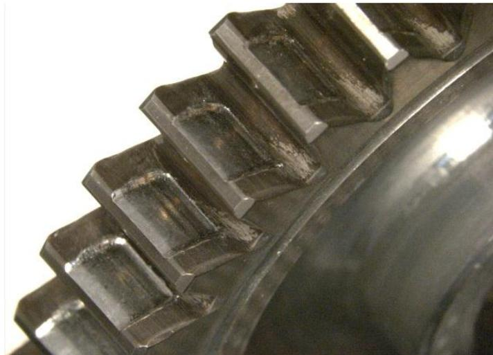
**Figure 1.6 :** Phénomène de rupture par fatigue
