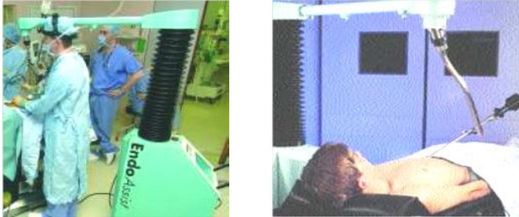
Figure 2.11: Le système Endoassist à gauche dans la salle d'opération, le système porte-endoscope à droite.
