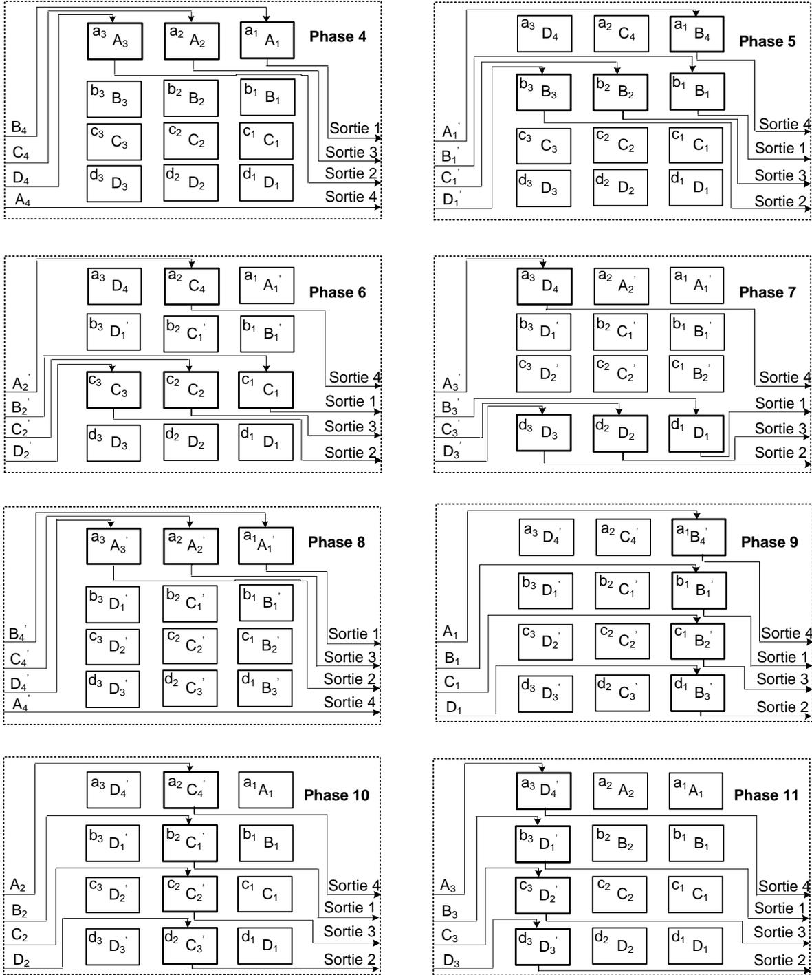
Figure 4.12 : Illustration de la procédure de lecture/écriture des RAMs pour l'unité d'ordonnancement des entrées pour l'architecture  $MR2^2-2^3-MDC$  à quatre séquences.
