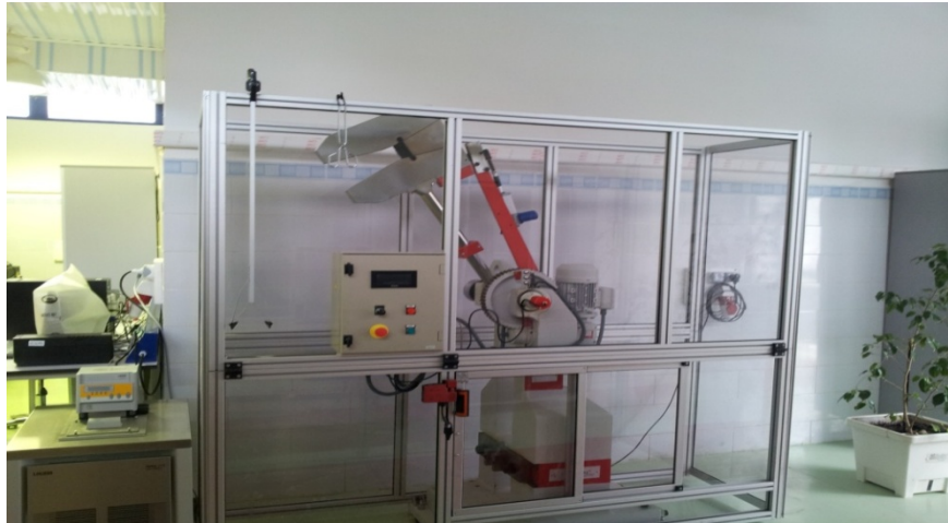
Figure III.12 : Mouton pendule ou mouton de Charpy
