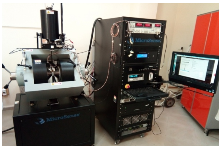
Figure III.18 : L'appareil des essais magnétiques utilisés (Modèle MICROSENSE)
