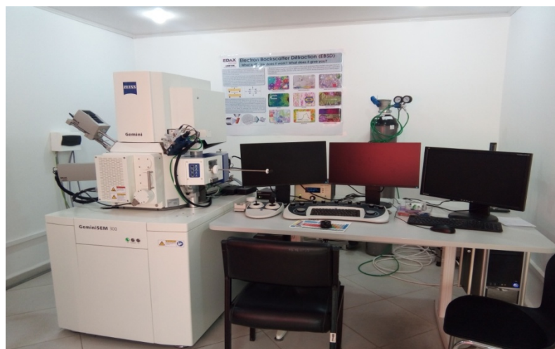
Fig III.8 : Microscope Electronique à Balayage (MEB) utilisé
