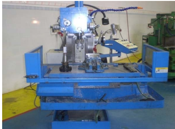
Figure III.3 : Fraiseuse utilisée pour le prélèvement des pièces découpées
