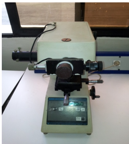
Figure III.9 : Micro uromètre semi-automatique
