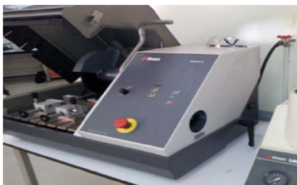
Figure III.4 : Outil de découpage utilisé
