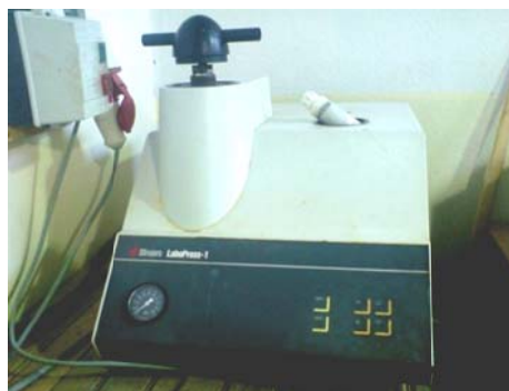
Figure II.5 : Appareil de l'enrobage utilisé.
