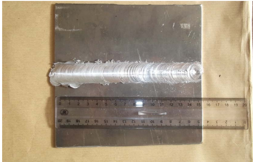
Figure 3.9 : Cordon de soudure FSW de notre matériau
