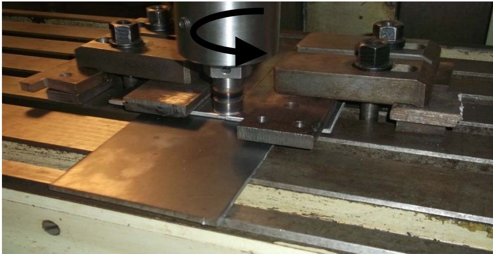
Figure 2.19 : Phase de Pénétration de l'outil
