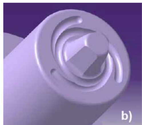
Figure 2.14 : Type d'épaulement a) Rainures complètes; b) Rainures partielles . [2.12].
