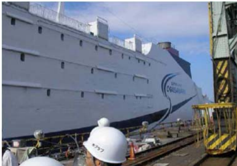
Figure 2.8 : Bateau en aluminium construit en utilisant le procédé FSW. [2.9].
