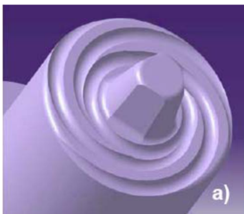
Figure 2.14 : Type d'épaulement a) Rainures complètes; b) Rainures partielles . [2.12].
