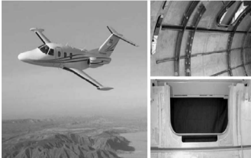
Figure 2.7 : Assemblage de l'avion Eclipse avec le procédé de FSW. [2.8].
