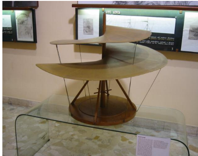
Figure 1.8: Maquette de vis aérienne de Léonard de Vinci du musée des sciences et des techniques Léonard de Vinci à Milan
