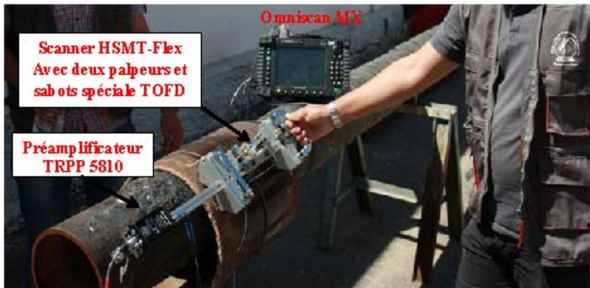
Figure 1.9 : Chaîne d'acquisition d'image TOFD par contact
