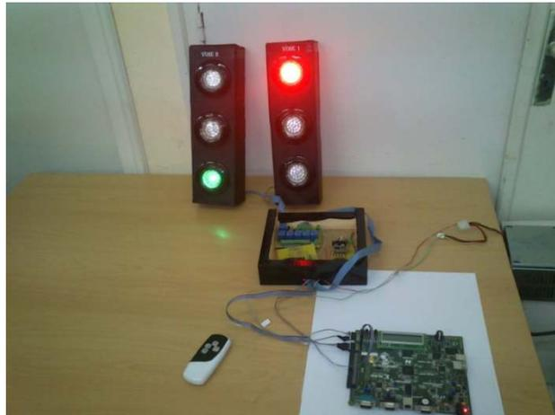
**Figure 4.15** système de contrôle des feux à distance
