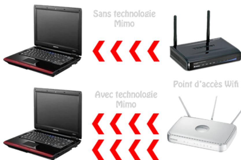
Figure 3.7 : la technologie MIMO dans un réseau Wifi.
