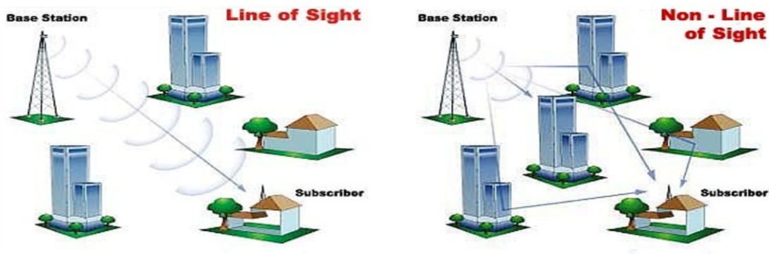
Figure 1.5 : propagation LoS et NLoS.
