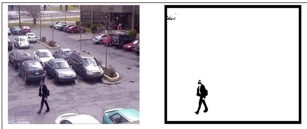
Figure 1.8 Segmentation d'un individu dans une séquence vidéo [2]
