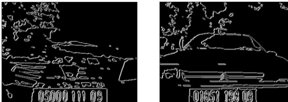
Figure 4.11 Détection de contour avec la méthode de Prewitt
