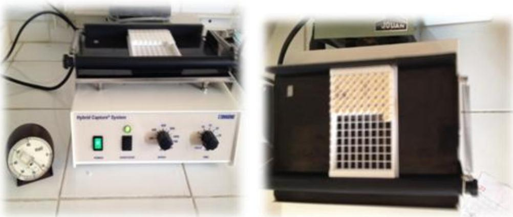
Incubation de la microplaque sur l'agitateur rotatif
