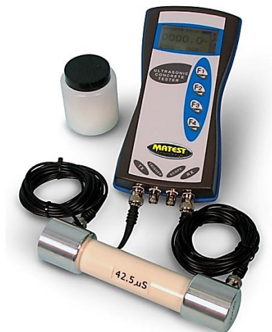
Figure 6. 3. Le testeur C369N de vitesse d'impulsions ultrasoniques utilisé. (Source : auteur)
