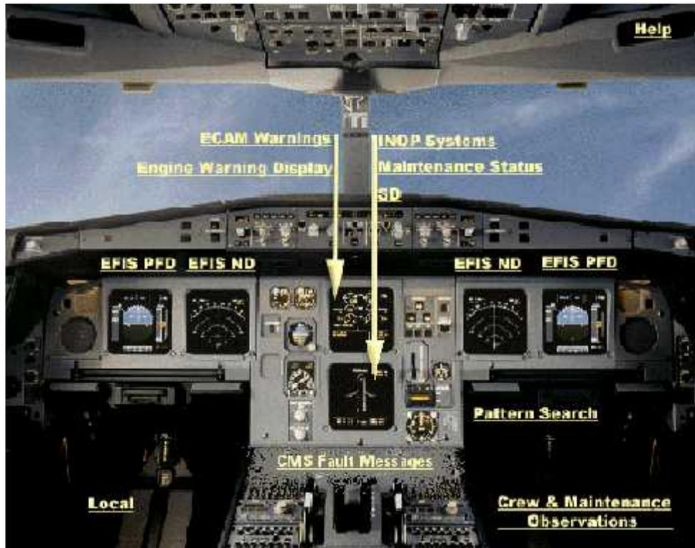
**Figure A.2 les écrans d'affichages d'un Airbus A330-200**
