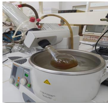
Figure 1.4. évaporation sous vide à l'aide d'un rota-vapeur de type Heidolph à température 70°C
