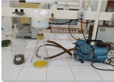
Figure 1.3. filtration sous vide à l'aide d'un verre fritté de porosité N°3
