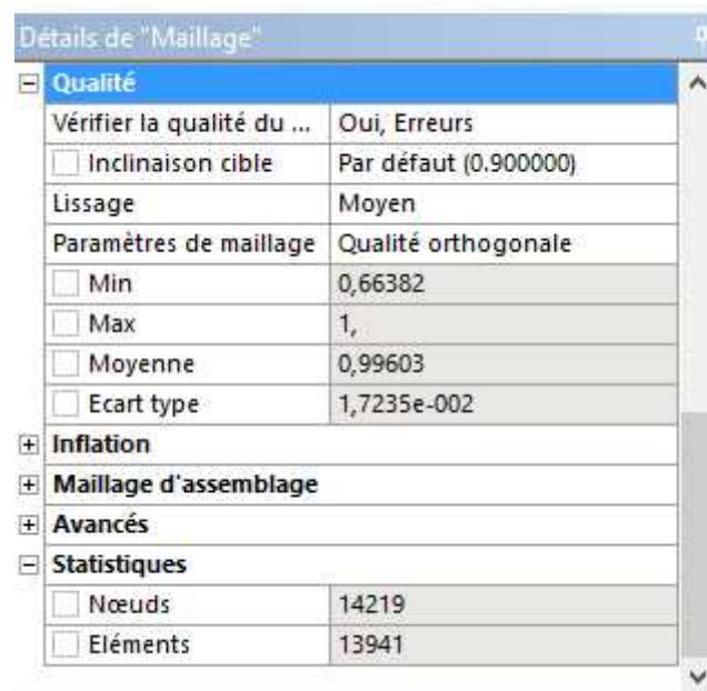
Figure (3-14) qualité du maillage du carré 2D avec le modèle SST et Reynolds 1600
