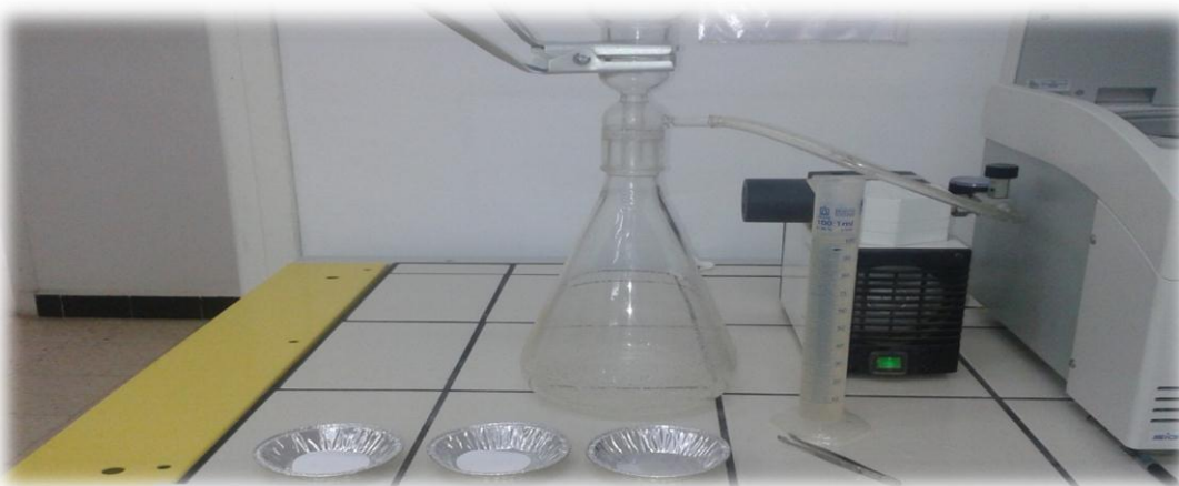
Photo N° 18 : Dispositif de filtration et membranes de filtration.
