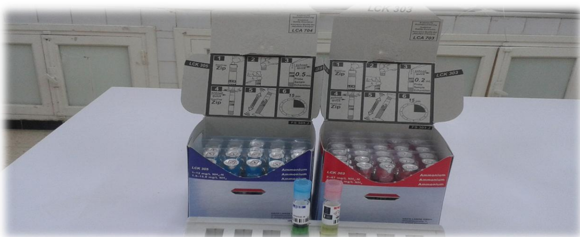
Photo N° 24: les kits LCK305 (à gauche) et les kits LCK 303 (à droite) pour l'ammonium
