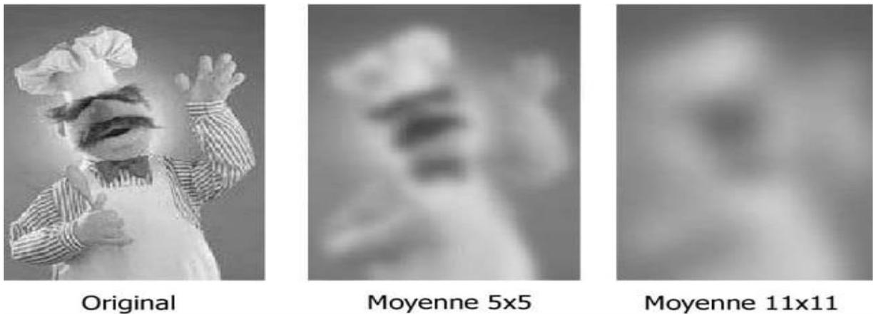
**Figure 2.9 :** Exemple de filtre moyenneur
