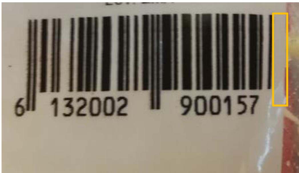
**Figure 3.21** : image non décodée, problème d'impression, manque de 2 barres au début du code barres.
