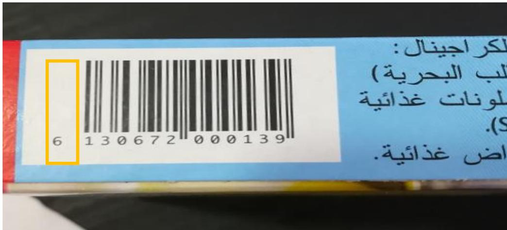
**Figure 3.20** : image non décodée, problème d'impression, manque de 2 barres au début du code barres.
