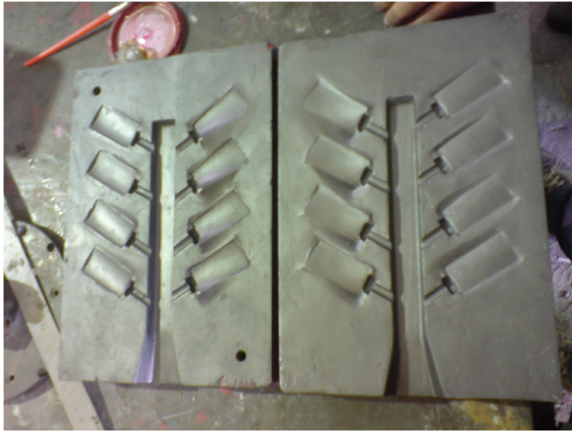
Fig. (4-21)-figure montrant le modèle avec couche de plombagine appliqué dessus
