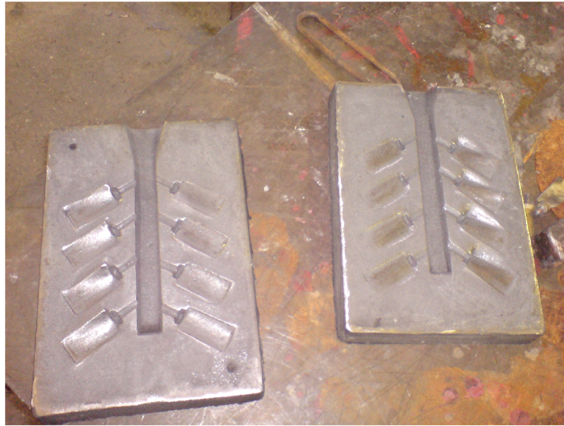
Fig. (4-25)-résultat finale de la coquille après usinage
