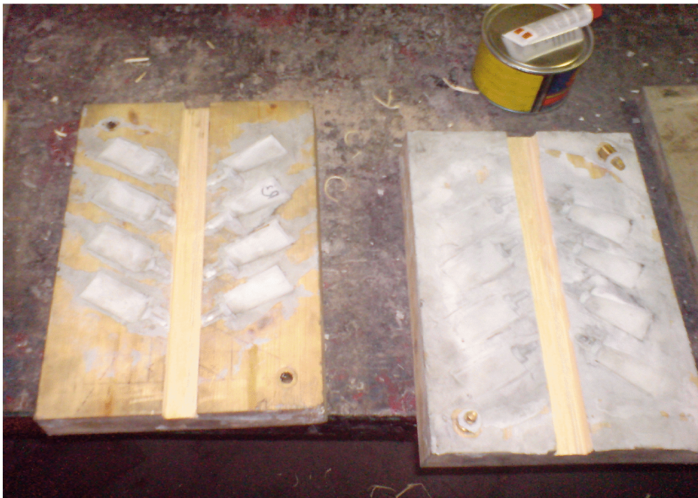
Fig. (4-18)-taillage du système de coulé (descente)
