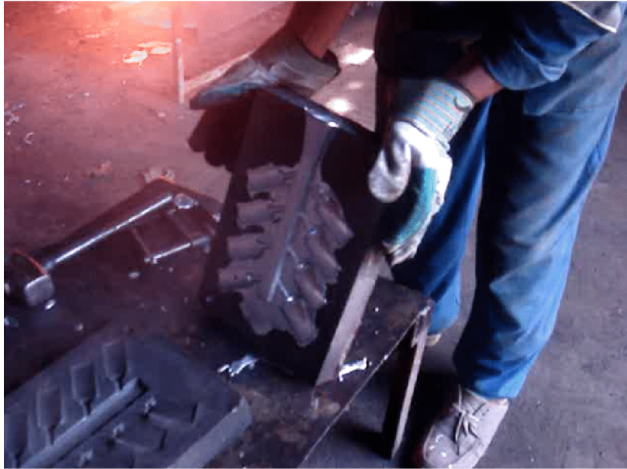
Fig. (4-32)-ouverture de la coquille afin d'extraire la grappe
