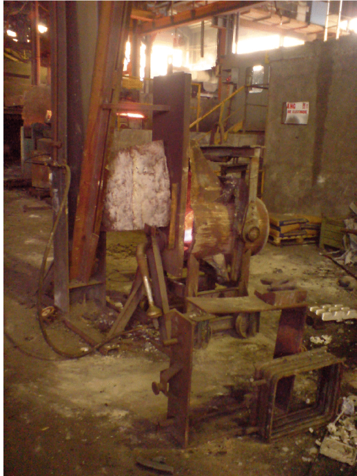
Fig. (4-27)-figure montrant le chauffage de la poche
