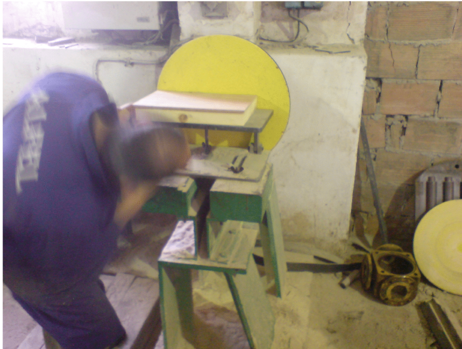
Fig. (4-11)-ponçage des parties externes du modèle
