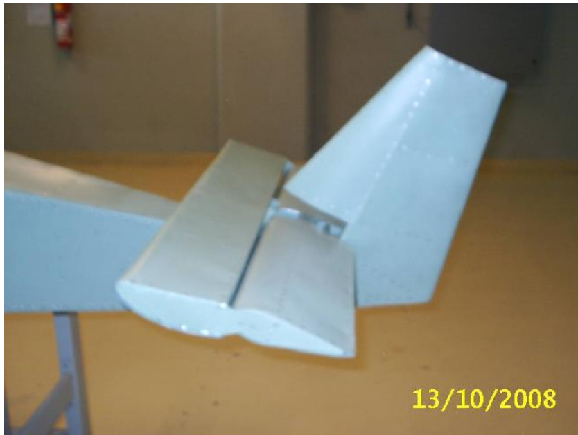
Fig (V-2) stabilisateur et l'élévateur
