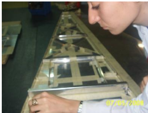
Fig. (IV_-1) traçage sur la tôle
