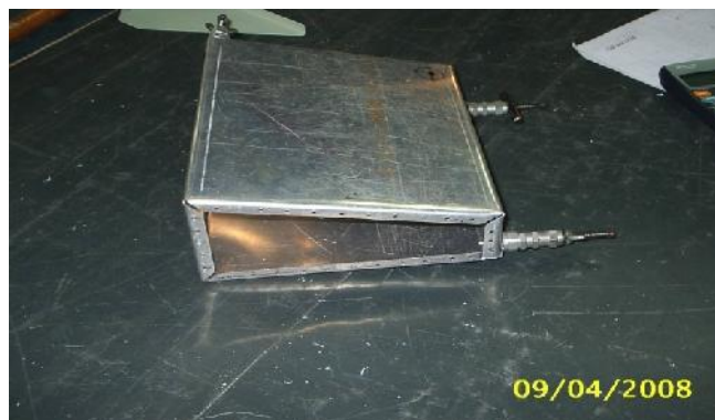
Fig. (III-8) réservoir carburant
