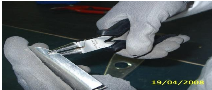
Fig. (III-4) formage des raidisseurs
