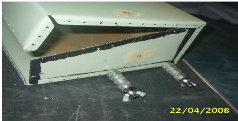
Fig (III-18) le PRC sur le réservoir
