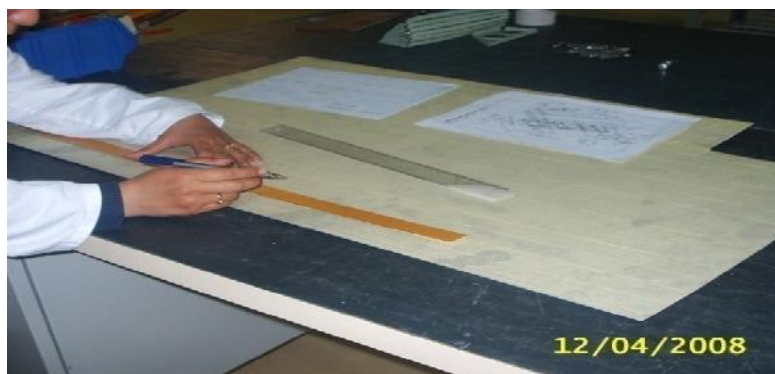
Fig. (III-2) traçage sur la tôle
