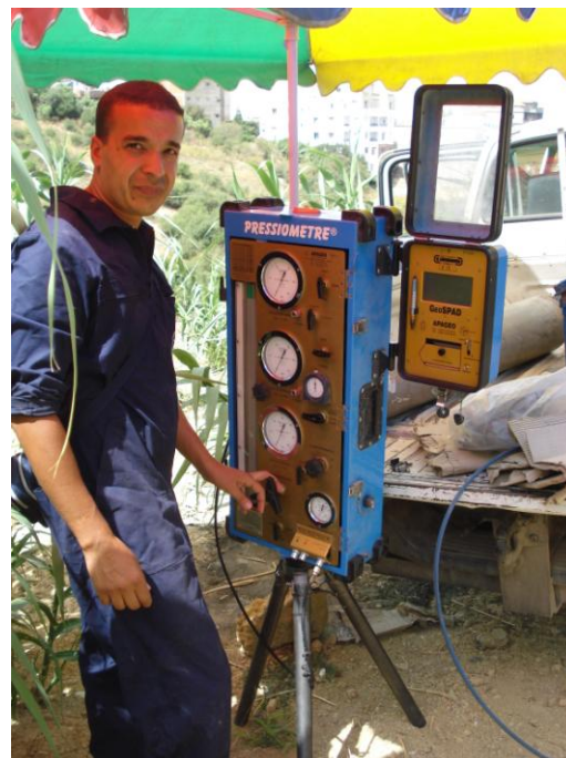
Figure 1.2: Le C.P.V. et les tubulures de connexion
