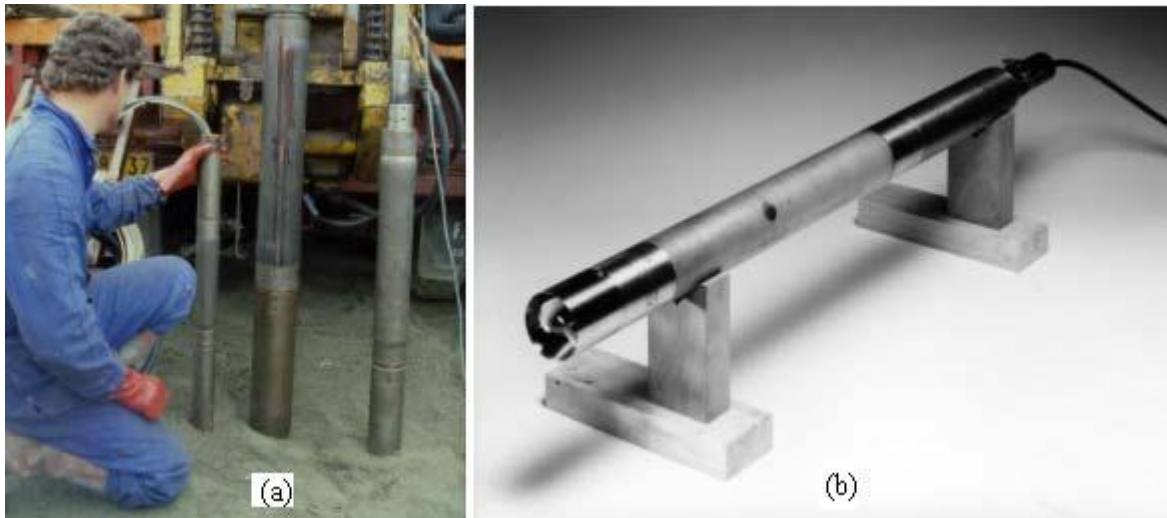
Figure 1.8: Les différents pressiomètres autoforeur : PAF 68, PAF 76 (a), Camkomètre (b)
