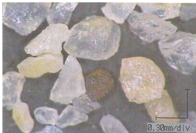
Figure 6.13: Vue microscopique des grains du sable d'Hostun RF, Tatsuoka (2005) [93].
