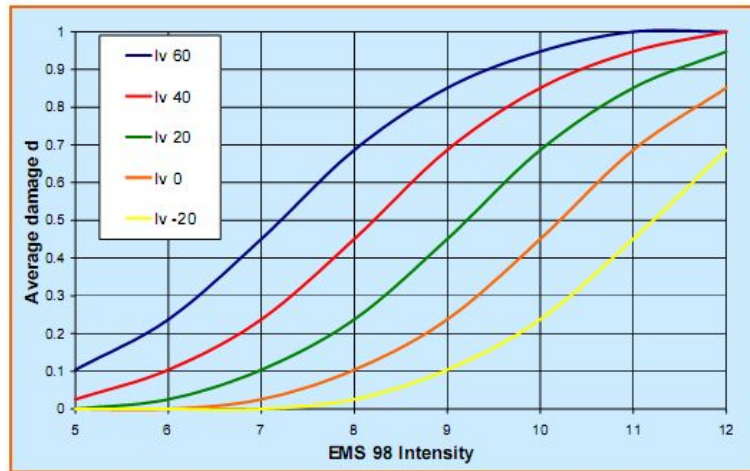
Figure 2.3 : Evolution du dommage moyen d en fonction de l'intensité du séisme (EMS98) pour plusieurs classes de vulnérabilité [8].
