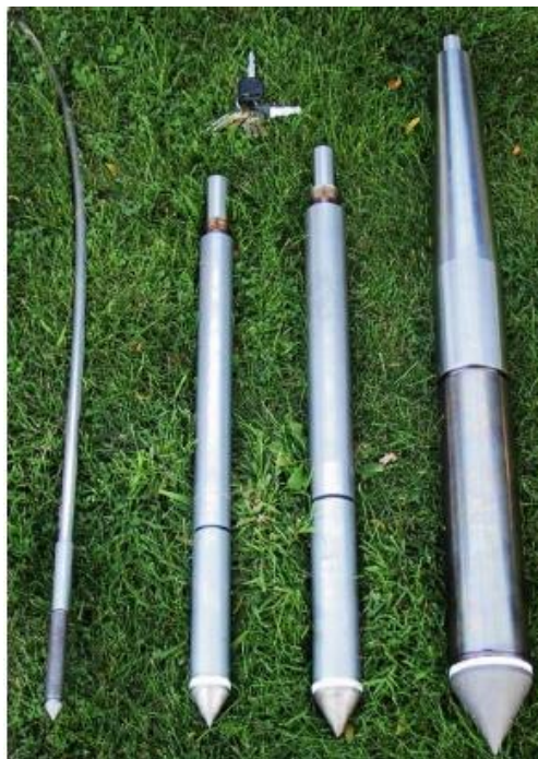
Figure. 1.10 : Différents modèles de CPT (du mini pénétromètre au pénétromètre 40 cm 2 )
