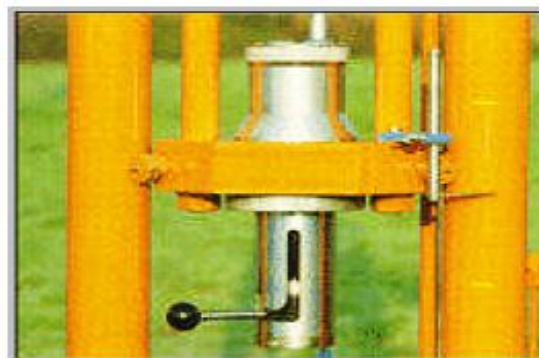
Figure 1.8 : Tête CPT pour enregistrement de données avec cônes mécaniques
