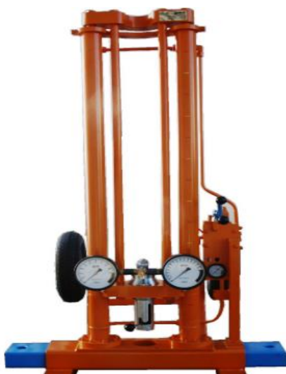
Figure 1.5 : Pénétrromètre 100kN portable, sur roues.
