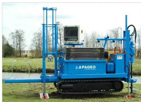
Figure 1.6 : Pénétrromètre 100kN sur chenillard, avec son système d'ancrage intégré et son rack à tiges amovible (bras articulés). Equipé ici avec un système complet d'acquisition de données dans son boîtier de protection étanche
