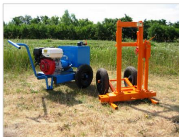
Figure 1.1 : Pénétrömètre 50 kN et son module séparé, portable sur roues.
