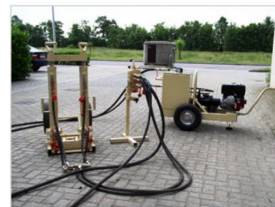
Figure 1.3 : Pénétrömètre 150 kN portable, entièrement démontable pour atteindre et travailler dans les zones les plus confinées.
