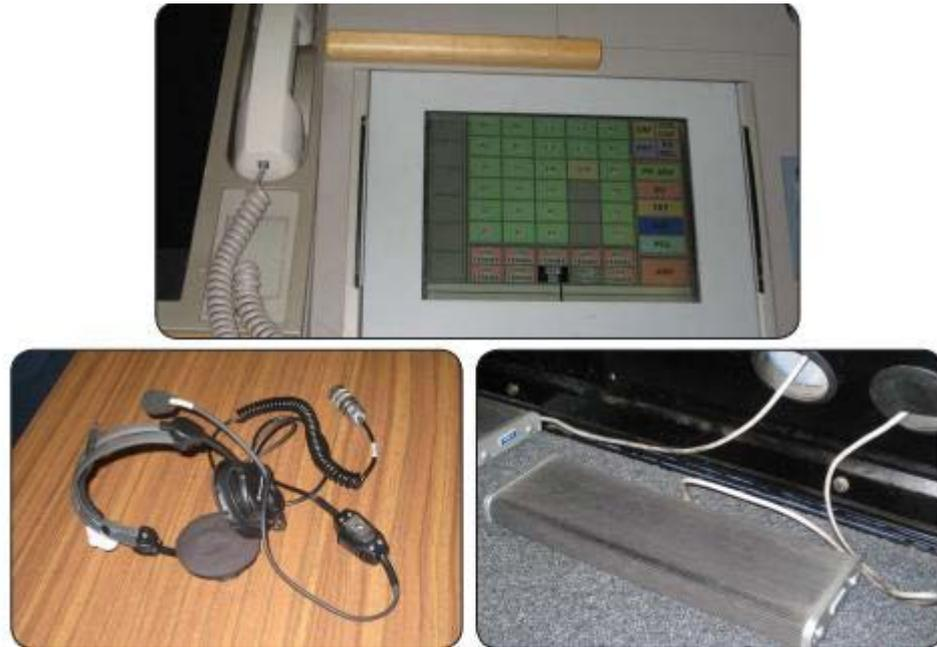
Figure 1. 5 : Les moyens de communications des contrôleurs. [6]
