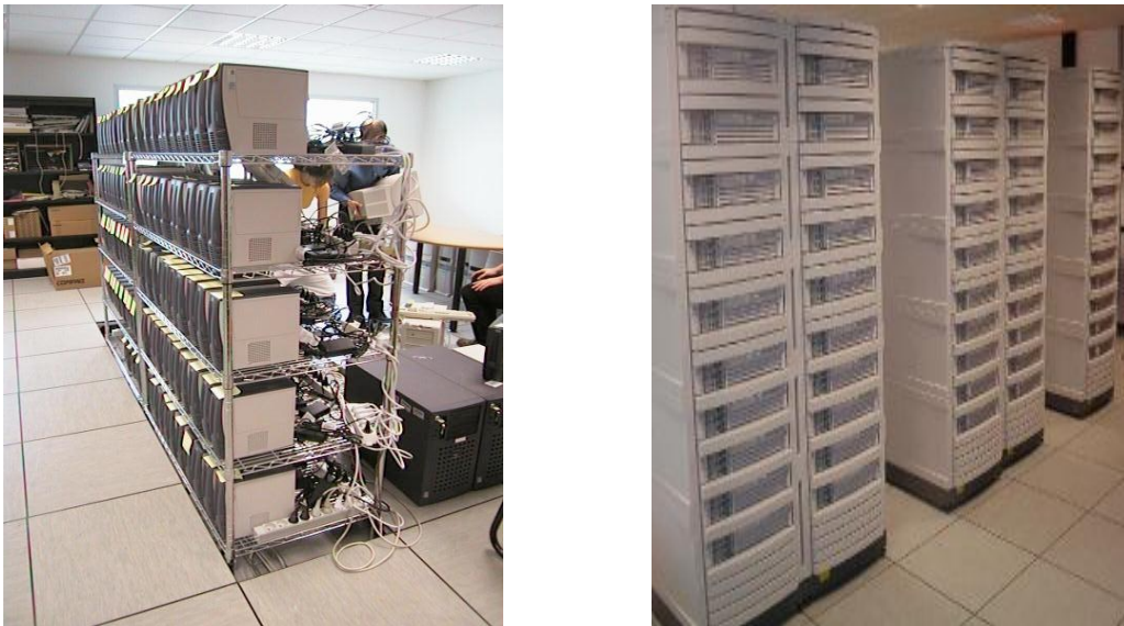
Figure 4.7 (A gauche) Grappe de PCs du projet iCluster (HP, INRIA, ID-IMAG) composée de 226 mono-processeurs Pentium III à 733 MHz avec 256 Mo de mémoire, inter-connectés via un réseau de 100 Mbit/s . (A droite) Grappe du projet iCluster2 composée de 104 bi-processeurs Itanium-2, 64 bits à 900 MHz avec 3 Go de mémoire, inter-connectés par un réseau Myrinet.
