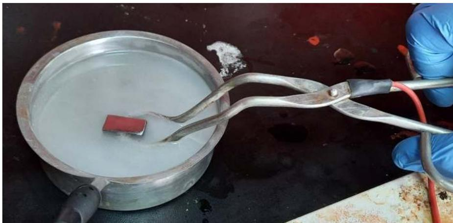
*Figure III.4:*Dispositif d'attaque électrolytique
