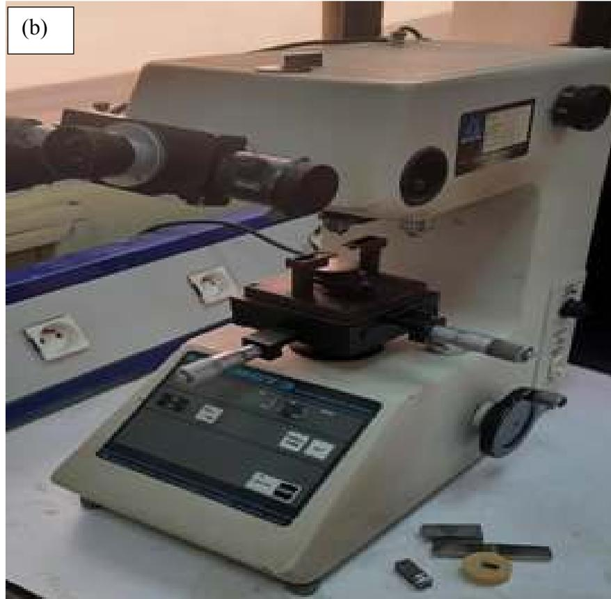
*Figure III.8:* (a) Principe de l'essai de Microdureté Vickers,(b) Microduromètre utilisé
