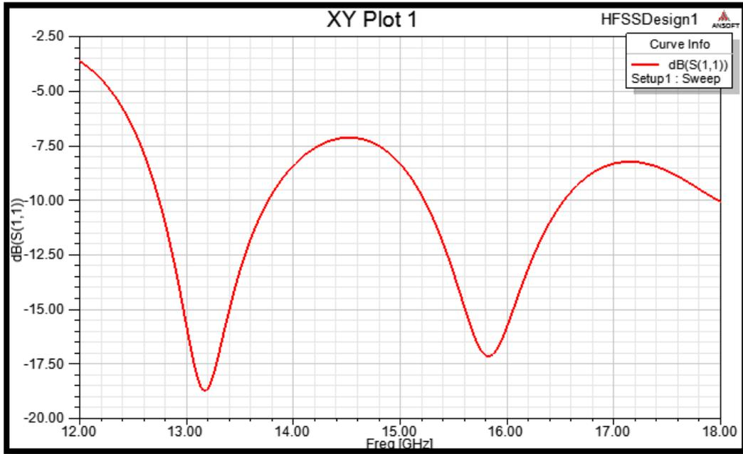
**Figure 3.13** Coefficient de réflexion  $S_{11}$  pour le réseau d'antenne de deux éléments
