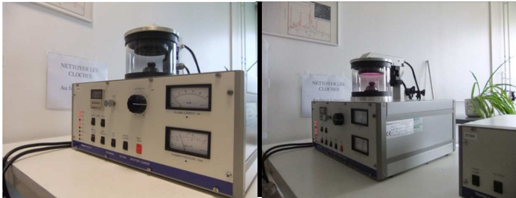
Photographie de l'appareil de métallisation avant et après déposition de la couche métallique.
