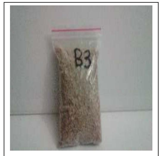
Figure 11. Prélèvement de matière première après 3eme étape de broyage de tuyauterie
