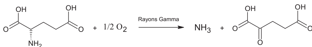
Schéma I.10 : Réaction de synthèse de l'acide 2-oxoglutarique à partir de l'acide glutamique
