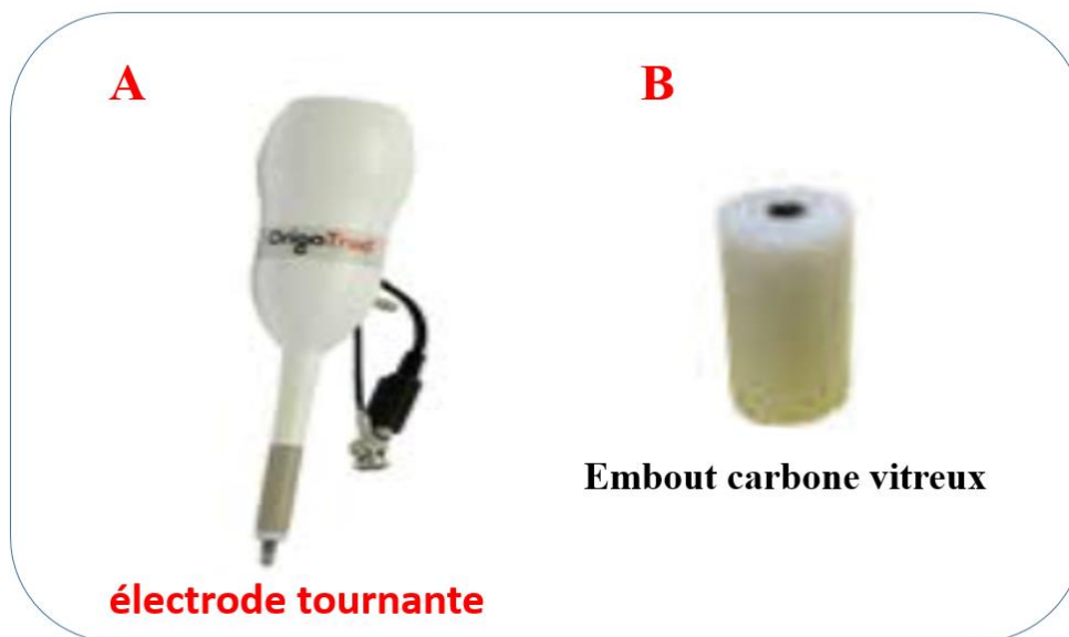
Figure 2.12 : Photographies. A) Électrode tournante, B) Embout en carbone vitreux.
