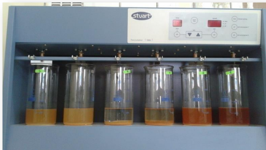
Figure .3.2. Coagulation décantation par le chlorure ferrique \text{FeCl}_3 à 30 min d'agitation lente
