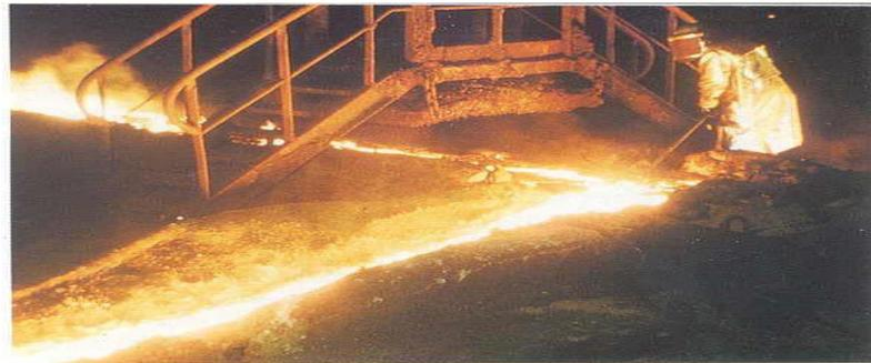
Figure 1.45 : Coulée de laitier à la sortie du haut fourneau [124].
