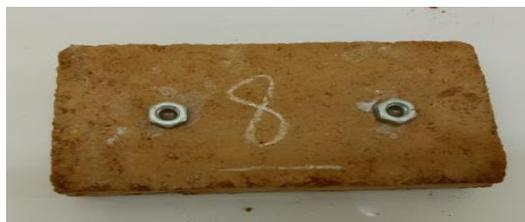
Figure 2. 8 : Éprouvette réalisée pour l'essai de gonflement et de retrait.
