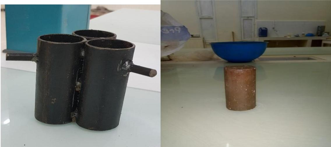
Figure 2.6 : Carottes métalliques pour le prélèvement des éprouvettes de l'essai de la compression uniaxiale.
