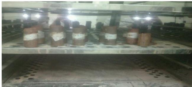
Figure 2.12 : Étapes de l'essai de séchage - mouillage (séchage dans l'étuve).
