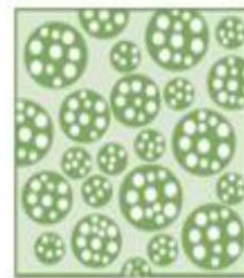
(c) Béton de granulats légers
