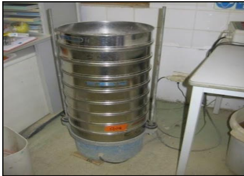
Figure 4.6 : Essai granulométrique : Tamiseuse électrique.
