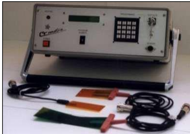
Figure 4.11 : Essai de conductivité thermique et de la chaleur spécifique par CT-METRE.
