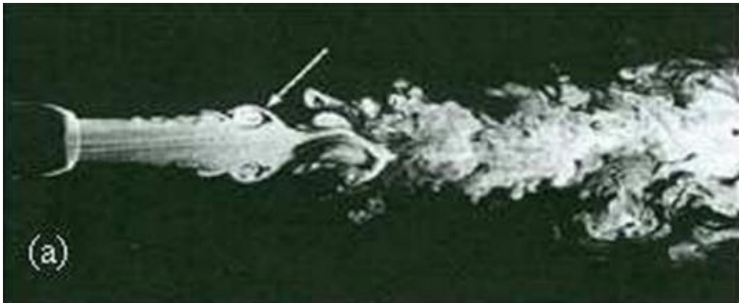
Figure.1-4 : schéma d'un jet rond libre éjecté par une buse convergente[6]
